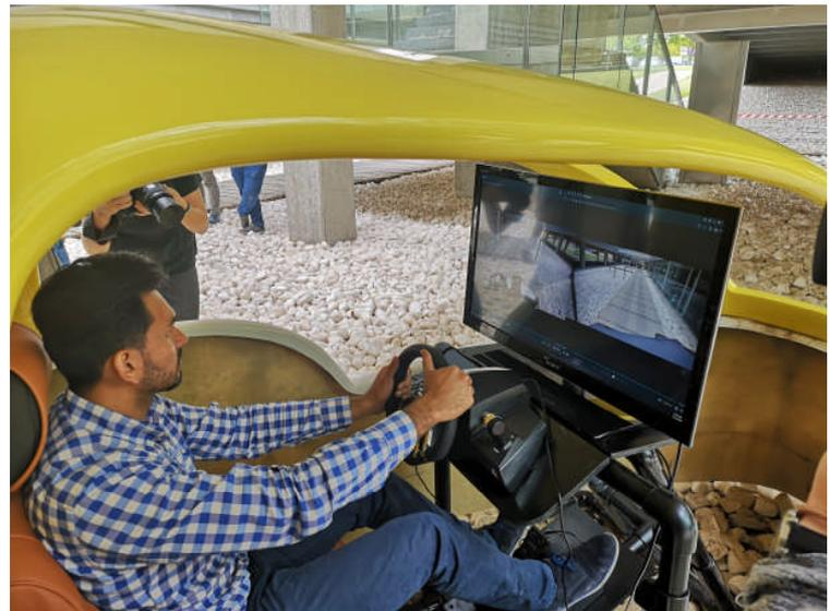
Otra de las aplicaciones que posibilitará la tecnología 5G es el manejo remoto de vehículos. Para realizar esta prueba, se utilizan cámaras que captan imágenes en alta resolución del entorno del vehículo y que, a través de la red 5G de Orange, llegan hasta el conductor remoto en tiempo real. La latencia de la red es tan baja que permite que la conducción a distancia sea completamente efectiva.
